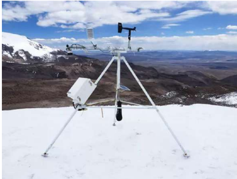
Figura 2. Instalación del EMA, en la UH Llaca en el marco del proyecto PASTURE
