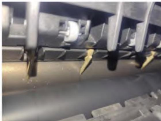
Se ha constatado que los rodillos de las bandejas 1 y 2 de la impresora presentan un alto grado de desgaste, lo cual afecta su capacidad de alimentación de papel y puede generar problemas en el proceso de impresión.
